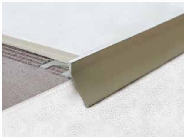
Bordertec BBR es el resultado de la optimización del Bordertec BBS, realizado para ofrecer una solución que cumpla la misma función pero con dimensiones reducidas. Se trata de un perfil pensado para acabar balcones y terrazas a embaldosar. El BBR ha sido diseñado para contener y proteger la baldosa y está provisto de un escurridor para permitir que el agua fluya, evitando mojar la parte frontal de la solera.
